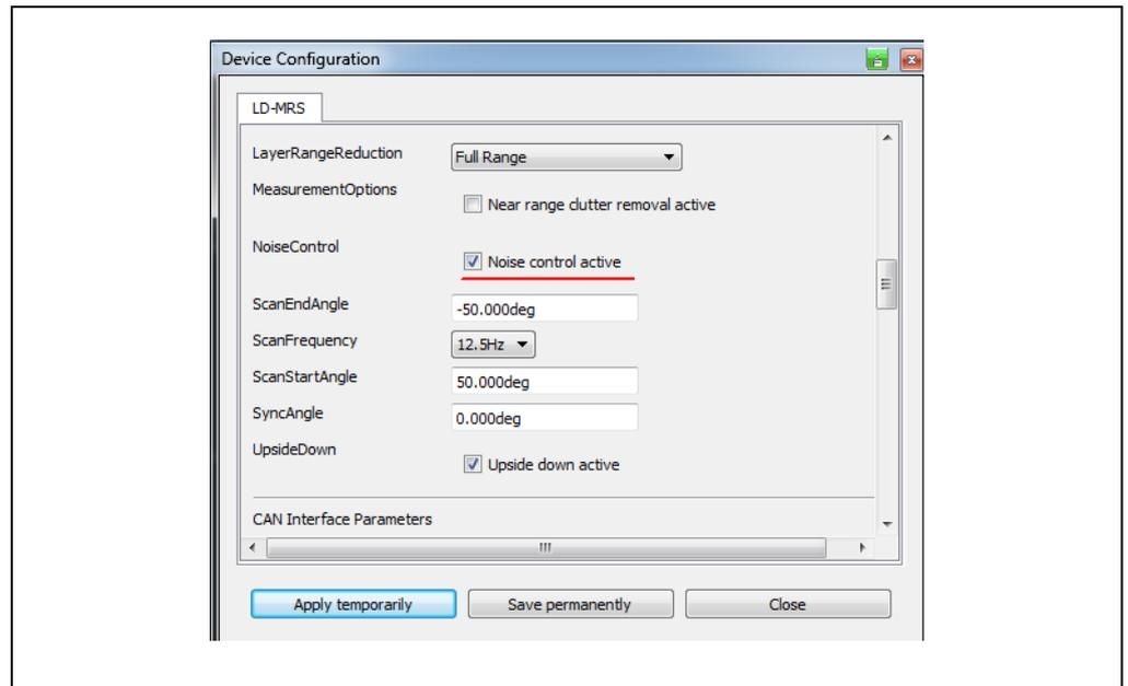
Fig. 3-28: „Noise Control“-Filter
